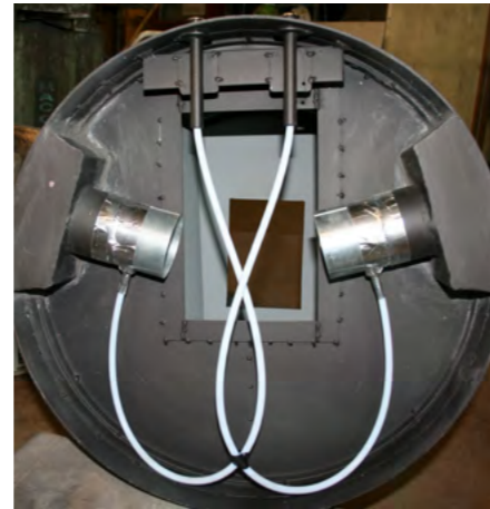
In den Sockelteil des Zylinderofens wird die Frischluft integriert. Dabei sind zwei einzeln zu bedienende Klappen vorhanden.
