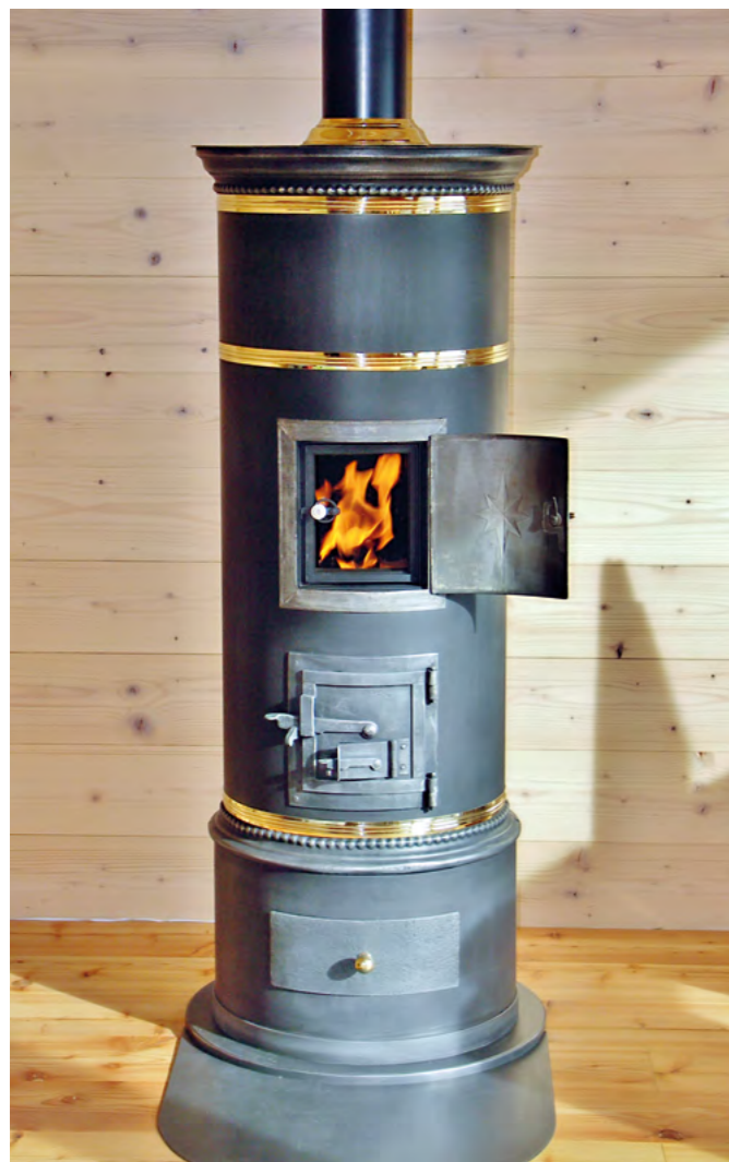
Diese schlichten Zylinderöfen sind eine Schweizer-Spezialität. Quer durch das ganze Land sind diese in stilistischen Nuancen regional gebaut worden. Die profilierten Simse sind auf dem drehenden Holzmodell hergestellt, dies mit dem Kunsthandwerk des «Metalldrückens». Dies wird heute nur noch sehr selten gemacht, der Beruf ist leider am Aussterben.
